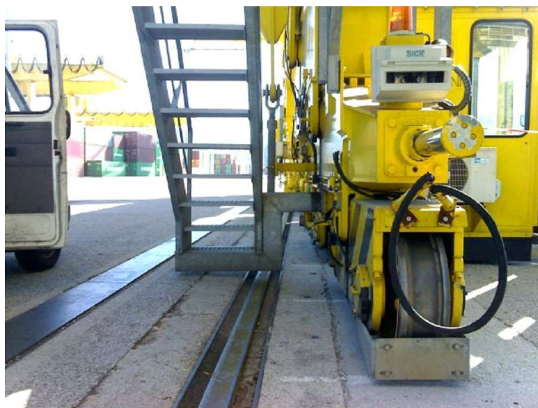
Grù Portainer trascinata fuori binario a seguito rottura ormeggi nave - causa vento
