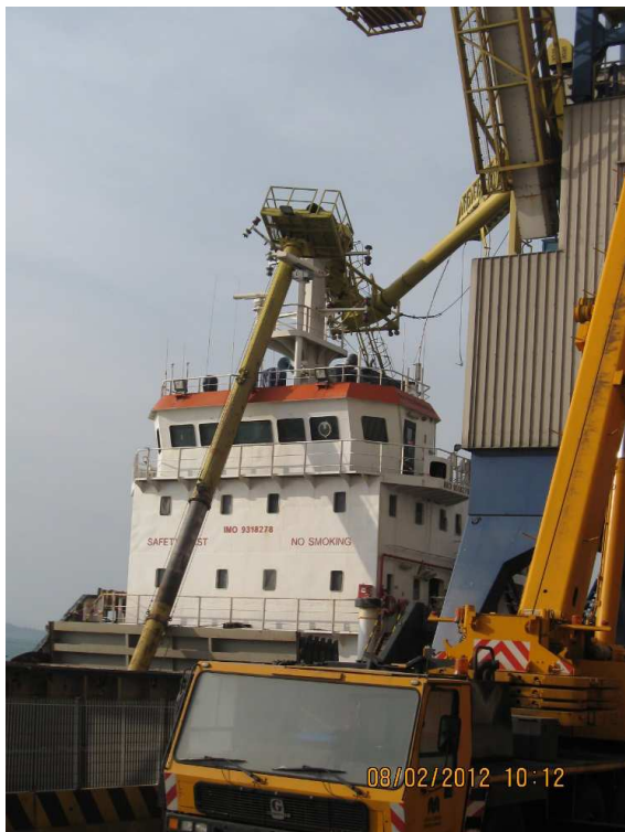
Torre scaricatrice collassata causa vento
